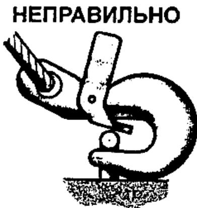
Рис.42. Установка палочного крюка в проушине неправильно
