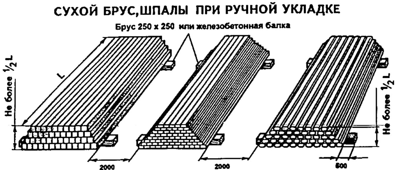
Рис.51. Складирование сухого бруса, шпал при ручной укладке
