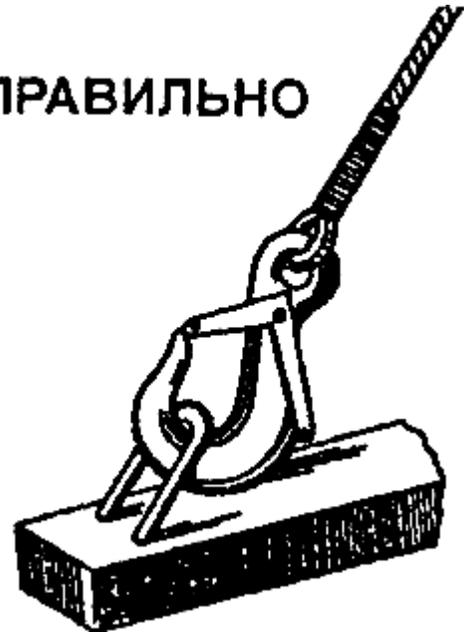
Рис.43. Установка палочного крюка в проушине правильно
